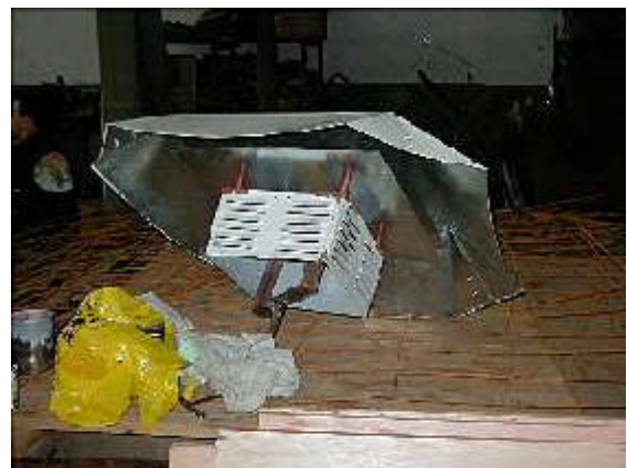
Figura 6: Resguardo metereológico para el HOBO de exterior
